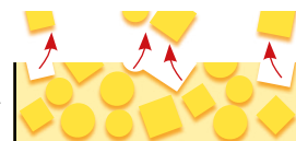
Surface devenant plus rugueuse et perte de brillance dans le temps
